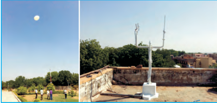
GPS Radiosonde Ascent
